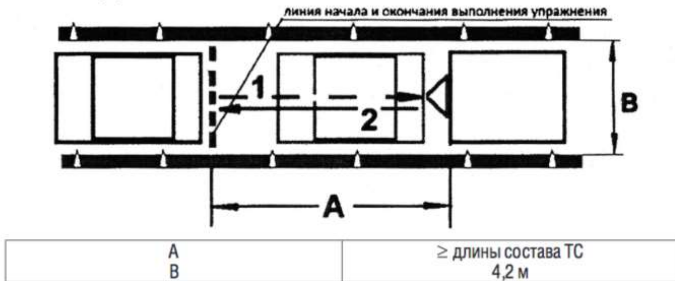
Рисунок 14. Схема и размеры элемента упражнения N 9 - "Сцепление прицепа с тягачом" 23.2. "Расцепление прицепа с тягачом".
